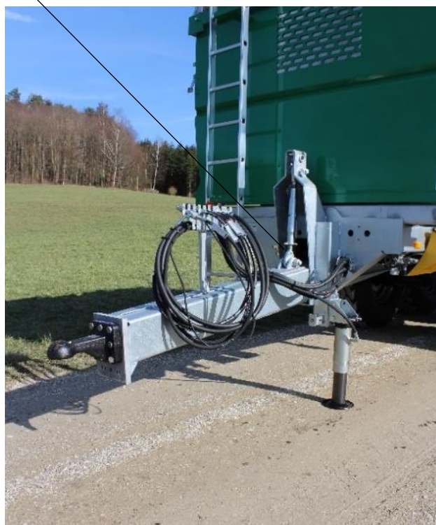
mech. verstellbare Deichsel (Serie)
