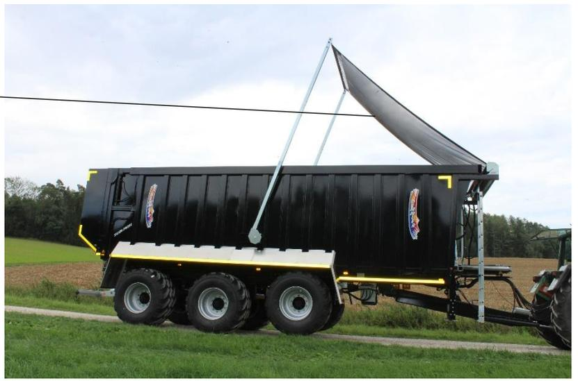
Hydraulisch betätigtes Klappdach mit
