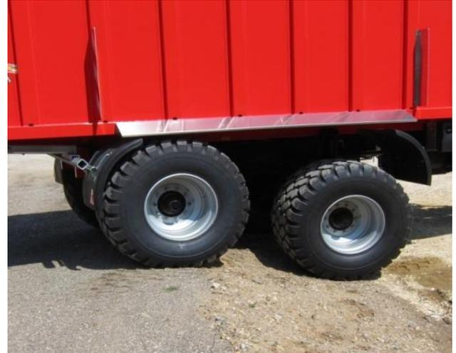
Hydraulisch gefedertes Achsaggregat
