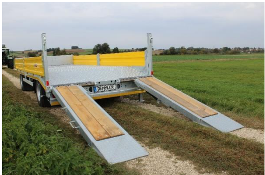
Geringer Auffahrwinkel durch abgeschrägte Ladefläche
