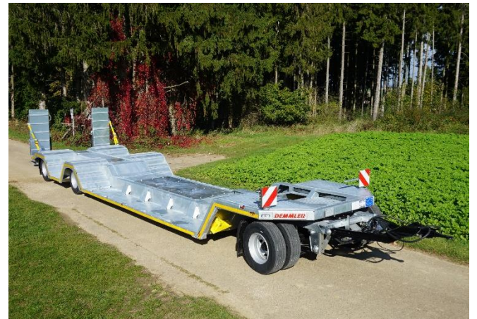
Tieflader zum Transport von Forstmaschinen PPF 30/40
