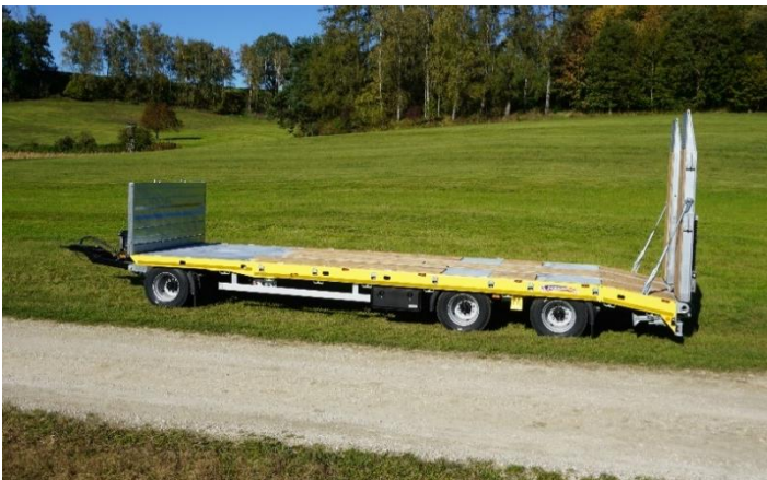
TÜ 3 mit grade Ladefläche vorne und stabiler Stirnwand
