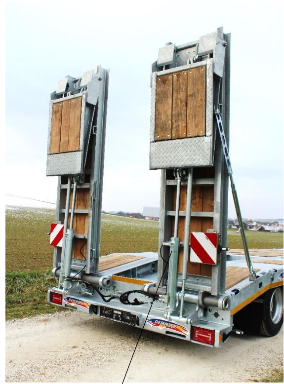
Rampen geteilt mit hydraulischer Bedienung (Aufpreis)
