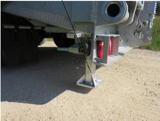
Mechanisch abklappbare Stützfüße (Serie)
