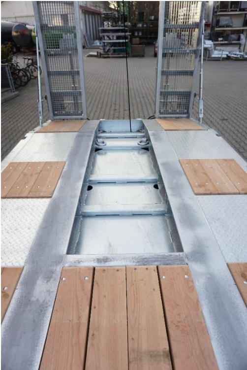
Geringer Auffahrwinkel durch abgeschrägte Ladefläche
