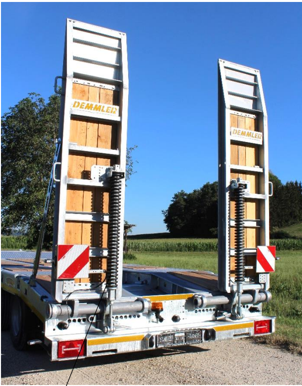
Rampen mit Federhebewerk (Serie)
