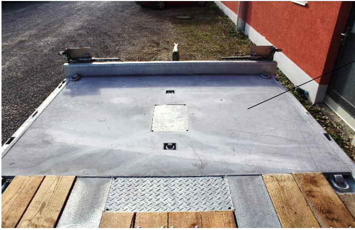
Gerade Ladefläche mit stabiler Blechplatte über dem Vordergestell
