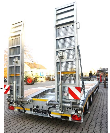
Rampen geteilt mit hydraulischer Bedienung (Aufpreis)
