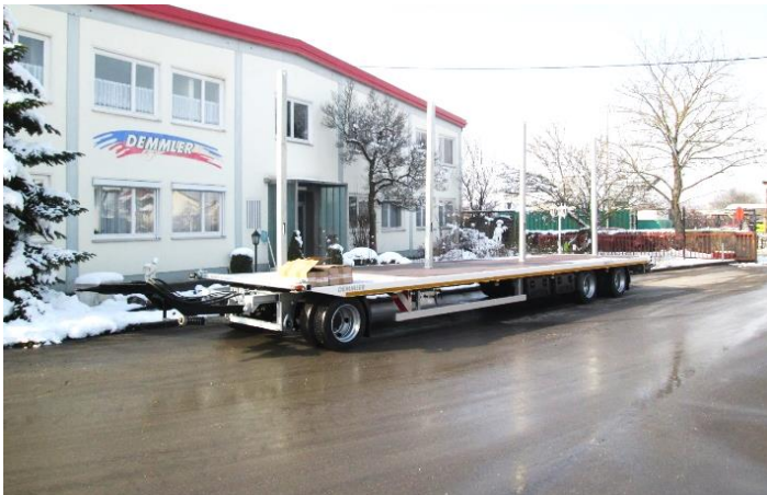
Tieflader mit gerader Ladefläche TP 3/21 zum Transport von Wechselbrücken
