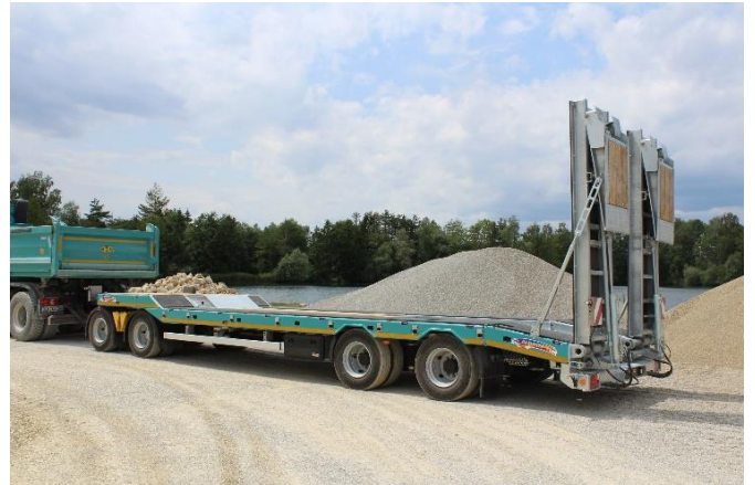
TÜ 4 mit geteilten hydraulischen Rampen
