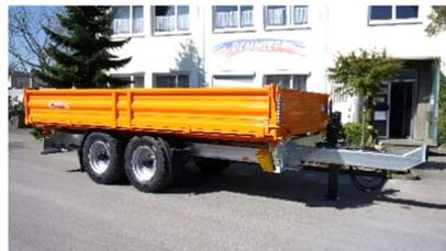
Tandem-Dreiseitenkipper Tiefloaderausführung u. Auffahrschienen
