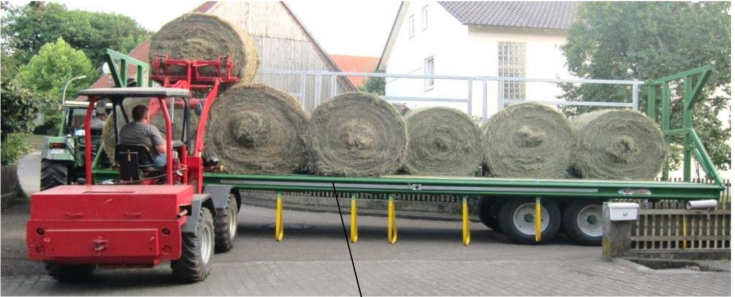
Dank der niedrigen Bauart, kann der Demmler Ballentransportwagen mit allen möglichen Ladegeräten be- und entladen werden.)
