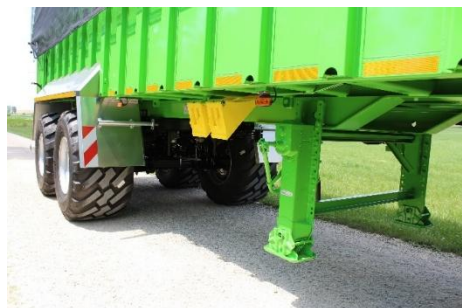
2-Gang-Sattelstützwinde zum sicheren Abstellen des Sattel-Abschieber
