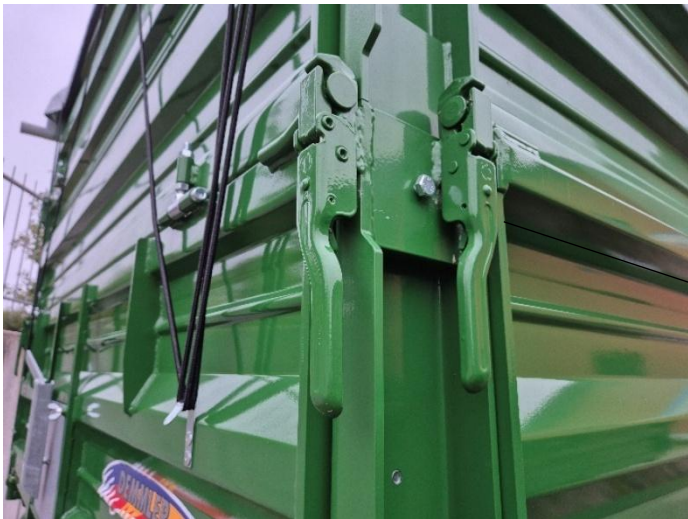
Ratschensicherung beim Planeaufbau
