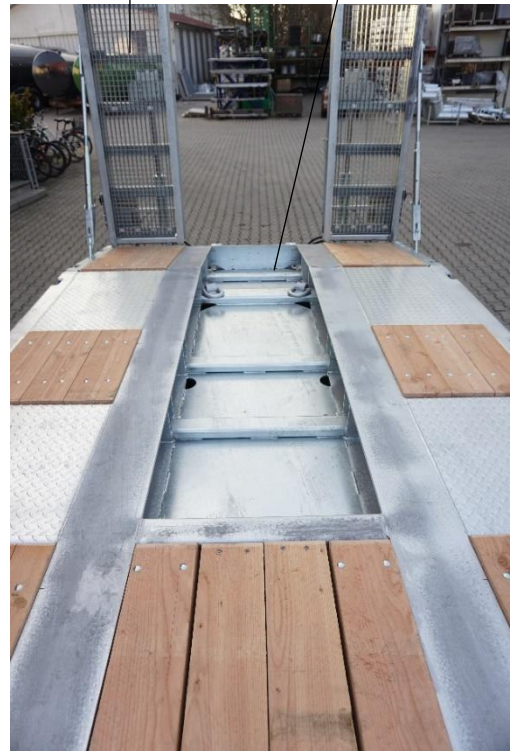
Geringer Auffahrwinkel durch abgeschrägte Ladefläche
