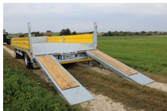
Geringer Auffahrwinkel durch abgeschrägte Ladefläche
