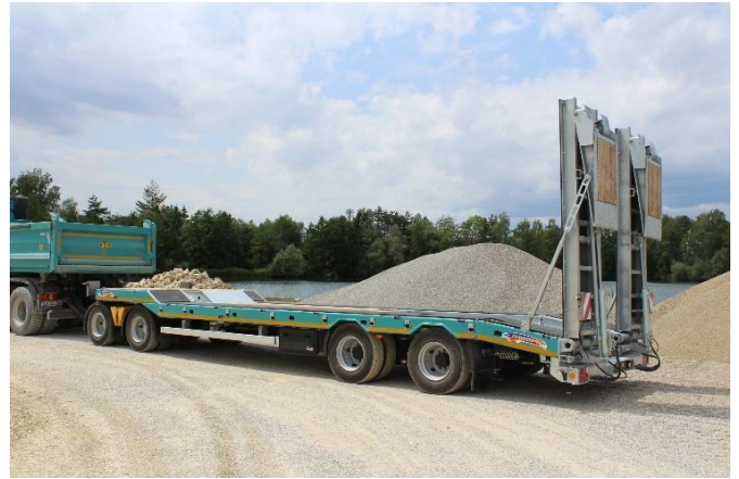
TÜ 4 mit geteilten hydraulischen Rampen
