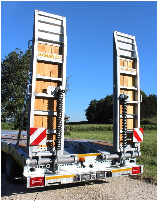
Rampen mit Federhebewerk (Serie)
