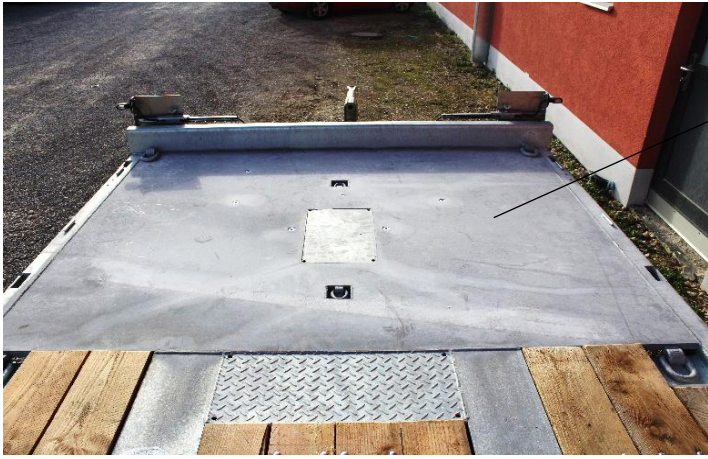
Gerade Ladefläche mit Blechplatte über dem Vordergestell für niedrige Bauhöhe
