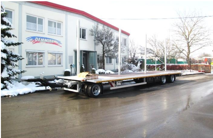
Tiefflader mit gerader Ladefläche TP 3/21 zum Transport von Wechselbrücken
