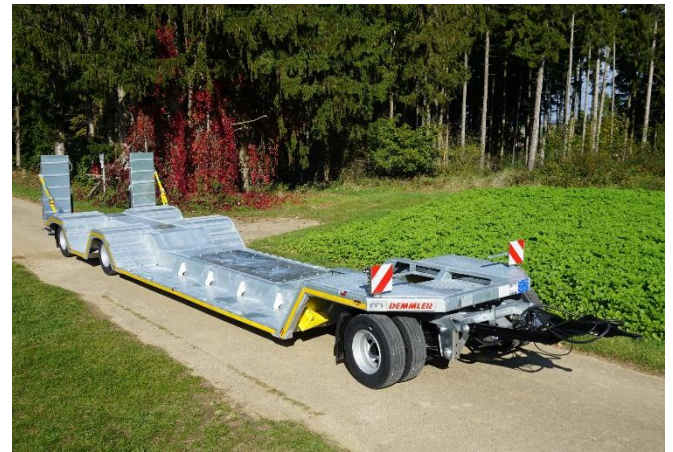
Tiefflader zum Transport von Forstmaschinen PPF 30/40
