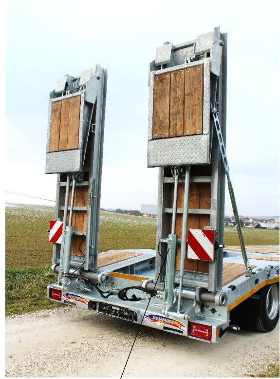
Rampen geteilt mit hydraulischer Bedienung auf/ab und Seitenverschub (Aufpreis)
