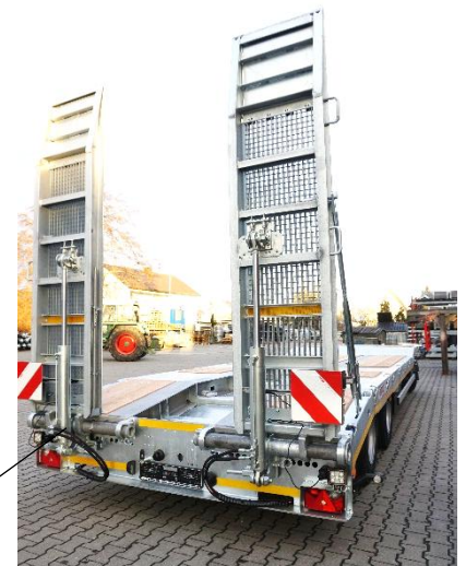
Rampen geteilt mit hydraulischer Bedienung auf/ab und Seitenverschub (Aufpreis)
