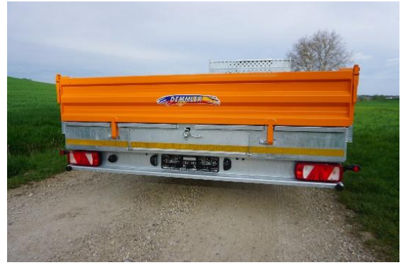
Tieflader mit gerader Ladefläche Stahl-Bordwänden, Stauraum und Alu-Auffahrampen
