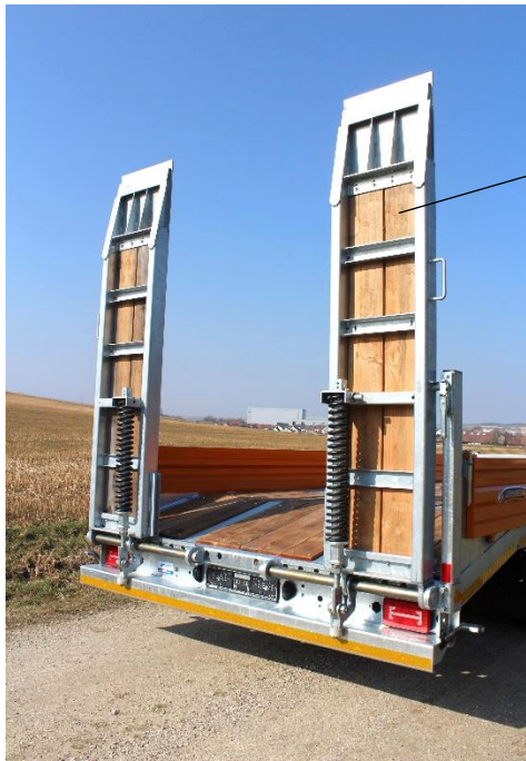
Automatische Abstützung an den Rampen (Aufpreis)
