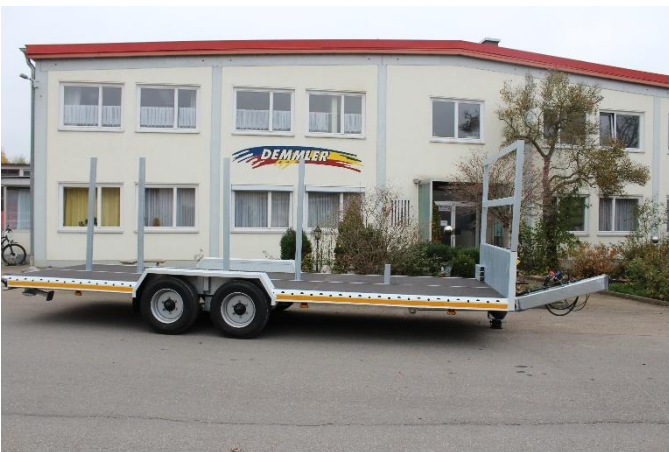
Tandem-Tieflader TTL 119 mit niedriger Ladehöhe 700 mm und Steckungen
