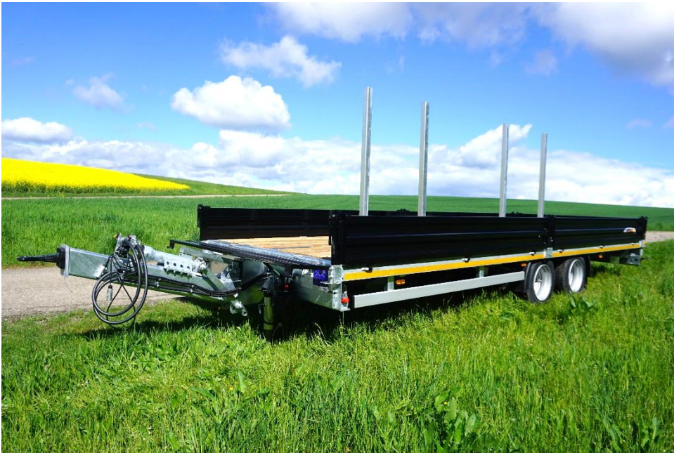
Rungenstecksystem und abklappbare Stirnwand
