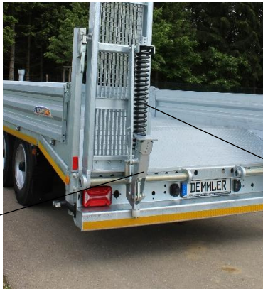
Abstützung vorne mit 2-Gang-Getriebestützwinde (Serie)
