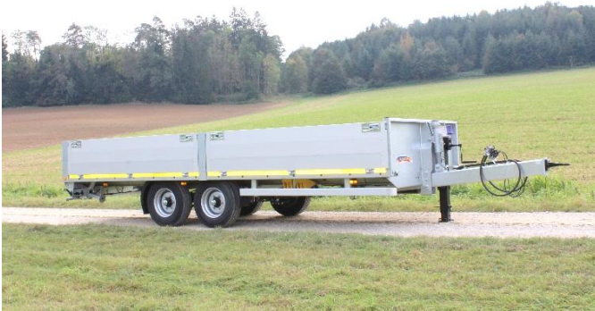
Tieflader mit gerader Ladefläche Alu-Bordwänden, Stauraum und Alu-Auffahrampen
