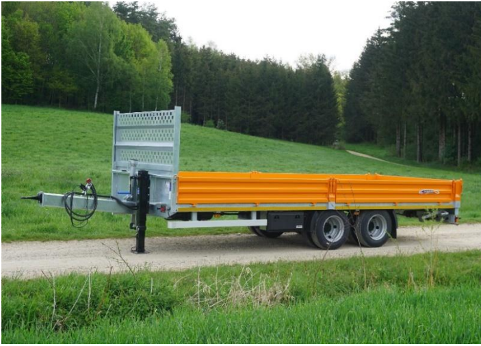
Tieflader mit gerader Ladefläche Stahl-Bordwänden, Stauraum und Alu-Auffahrampen
