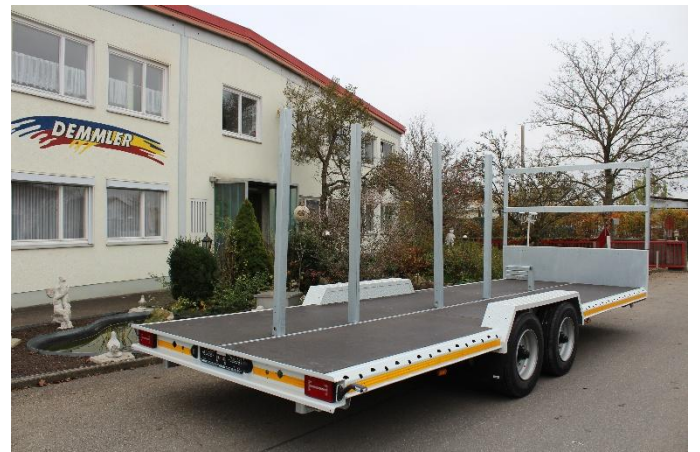
Tandem-Tieflader TTL 119 mit niedriger Ladehöhe 700 mm und Steckungen
