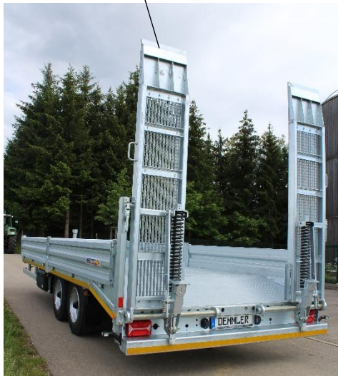
Rampen mit Gitterrost (Aufpreis)
