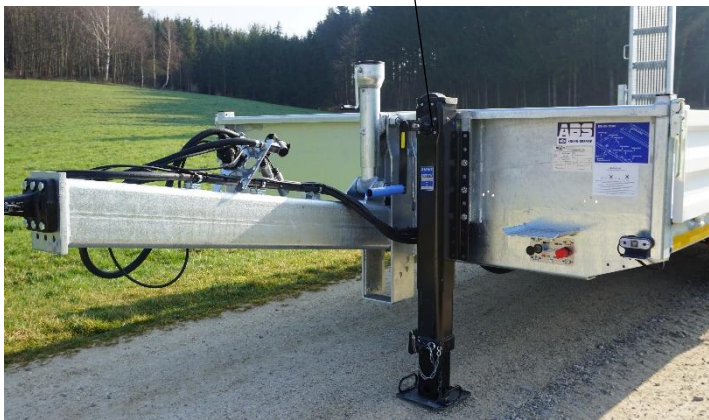
Abstützung vorne mit 2-Gang-Getriebestützwinde (Serie)
