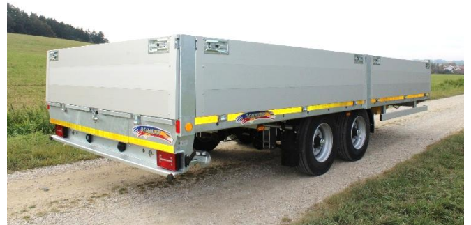
Tieflader mit gerader Ladefläche Alu-Bordwänden, Stauraum und Alu-Auffahrampen
