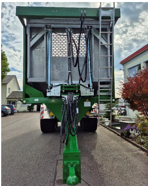
Kugelkupplung K 80 für 3 – 4 to. Stützlast
