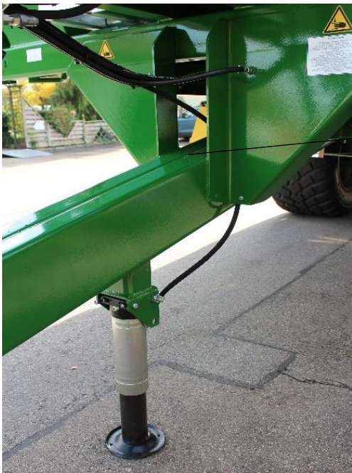
Starre Deichsel für Untenanhängung, hydr. Stützfuß (TSM light Serie)
