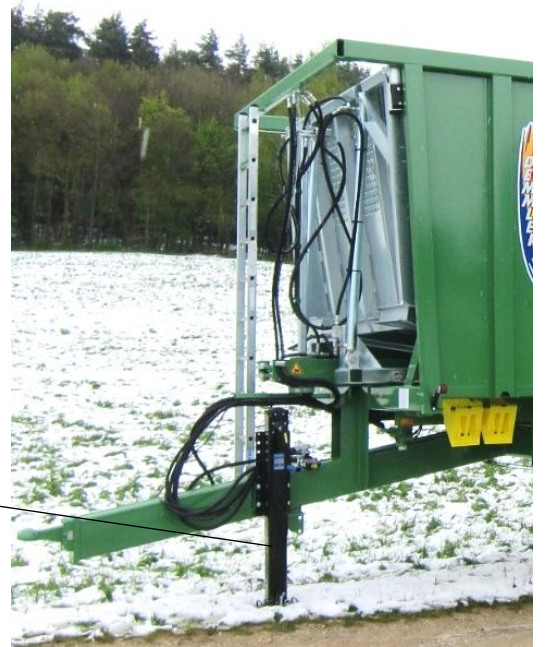
2-Gang Getriebestützwinde b. starrer Deichsel (TSM light Aufpreis)
