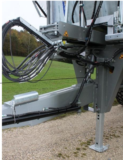
Hydr. gefederte Deichsel für Untenanhängung, mech Stützfuß (TSM Serie)
