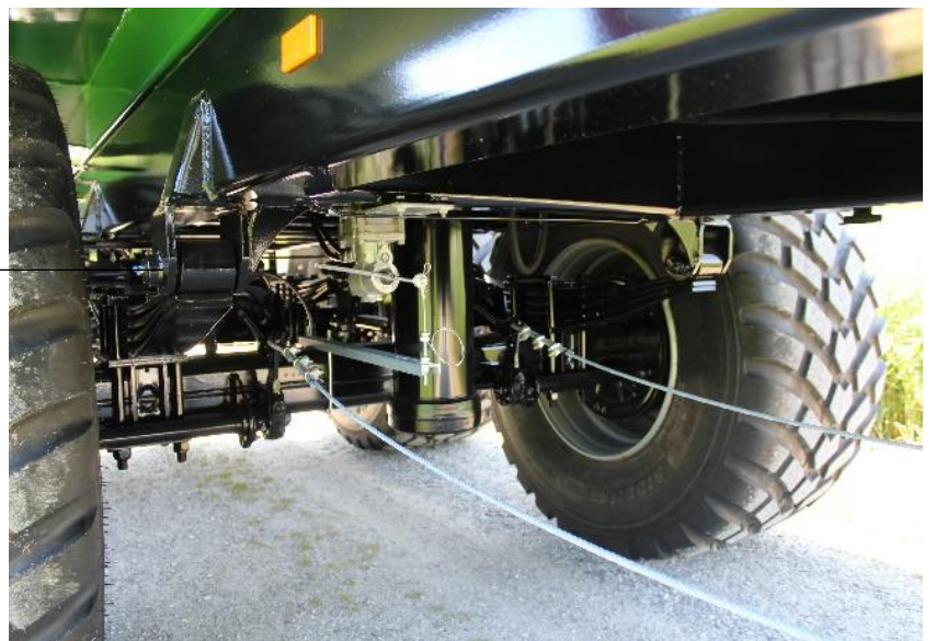
Verstärkte 4-Blatt-Parabelfederung (Serie b. TDM 2370 L/2380 L Niedrige Ladehöhe u. Schwerpunkt
