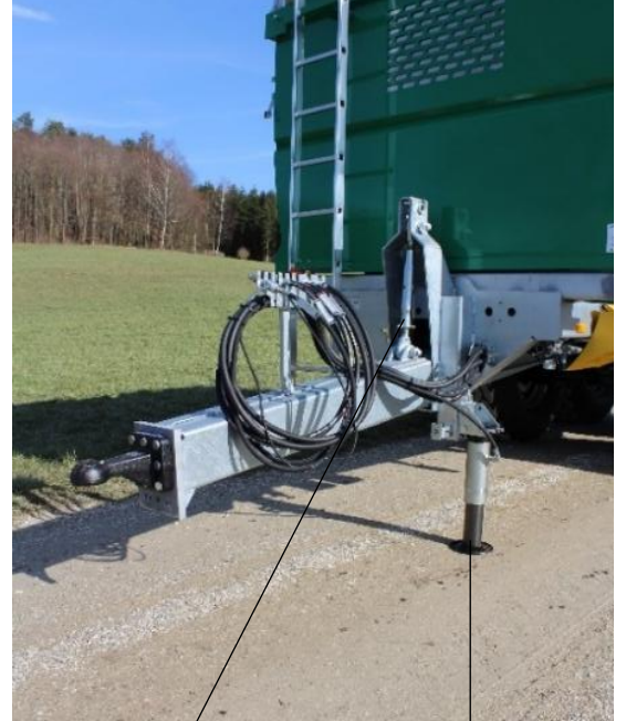
mech. verstellbare Deichsel (Aufpreis b. TDM 1650 L und TDM 1850 L)
