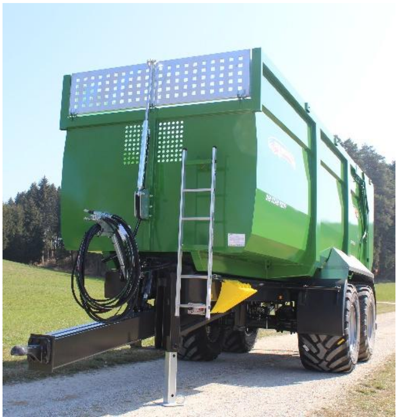
Stirnwandgitter hydraulisch abklappbar (Aufpreis nur bei Muldenhöhe 2000 mm)
