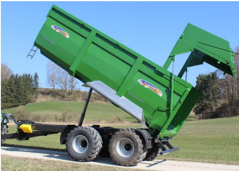
Großraumrückwand 750 mm (Aufpreis nur bei Muldenhöhe 2000 mm)
