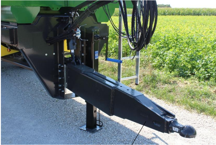
Schaftzugöse für großen Lenkeinschlag Gegen Aufpreis erhältlich bei TDM 2060 L - TDM 2380 L)
